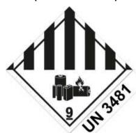
Nach SV 376 gilt bei der Beförderung von defekten oder beschädigten Lithium-Ionen-Batterien, dass das Versandstück mit der Aufschrift "beschädigte / defekte Lithium-Ionen-Batterien" (Größe 12 mm) gekennzeichnet sein muss
