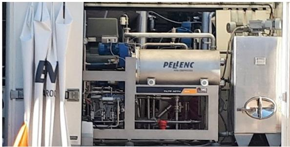
Le **FILTR'ACTIV D14** est un outil mobile de filtration qui offre la meilleure alternative aux technologies classiques de filtration rotative sous vide et autres technologies utilisant des terres de diatomées pour des liquides à haute teneur en matières solides en suspension (bourbes avec intrants, lies, rétentats et fonds de cuve).
